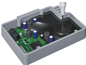
東和電気の主力製品のプリント基板に使われる樹脂材料
